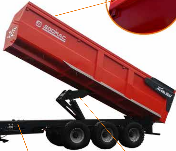
Bennage par compas ou vérin télescopique
